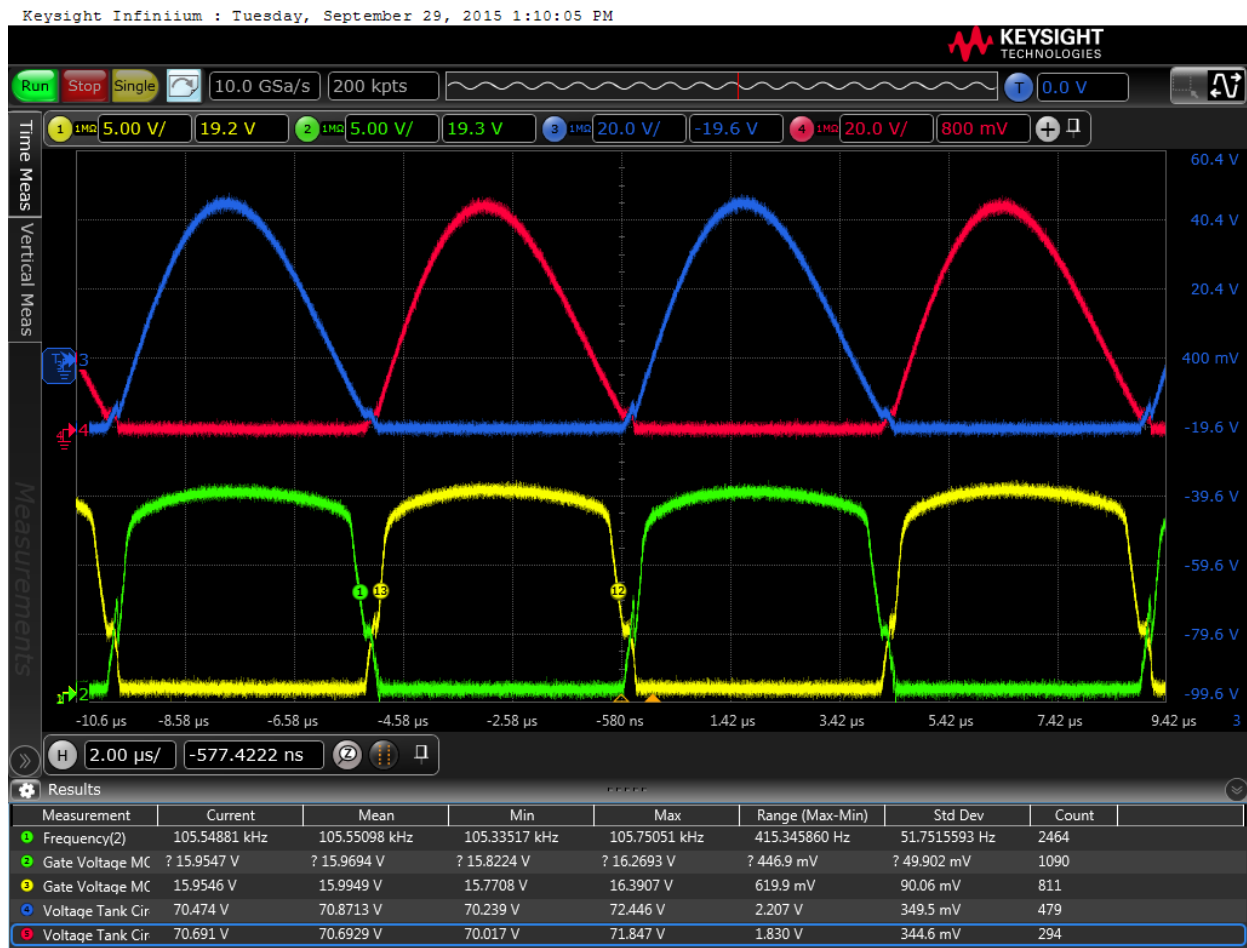
Abbildung 3: Blau und Rot sind die Spannungen an der Sendespule. Gelb und grün sind die Gate Spannungen (Diese gemessenen Spannungskurven sind referenziert gegen Schaltungs-GND; V_{in} = 20\text{ V} ; P_{out} = 100\text{ W} ; optimierte Gate Ansteuerung, siehe Applikationsbeispiele).
