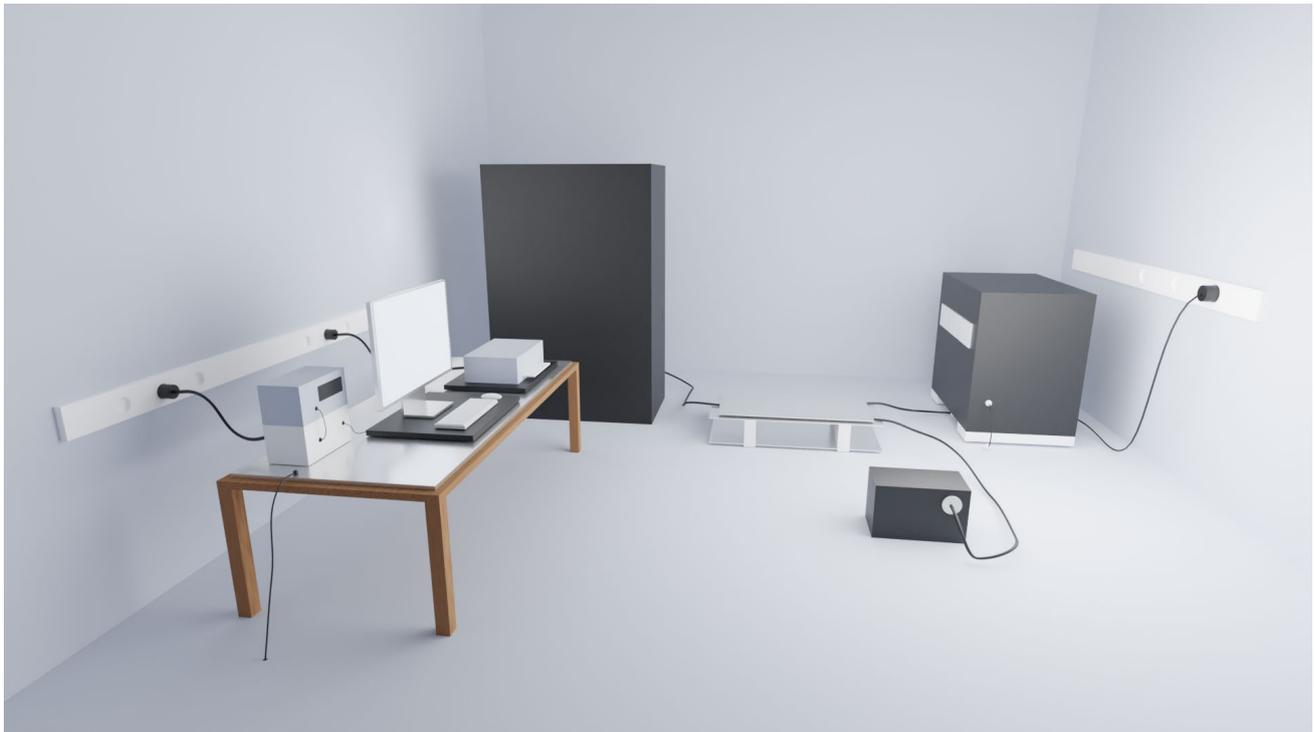
Abbildung 19: Aufbau der Burstprüfung nach DIN EN 61000-4-4:2013-04
