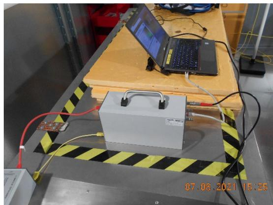
Abbildung 24: Surgeprüfung auf ungeschirmte Ethernetkabel. Oben: der normative Aufbau des Koppelnetzes nach DIN EN 61000-4-5:2014+A1:2017; Unten: die Umsetzung des Aufbaus mit Highspeed Koppel-Entkoppelnetzwerk und zusätzlichem Schutzfilter für die Hilfseinrichtung
