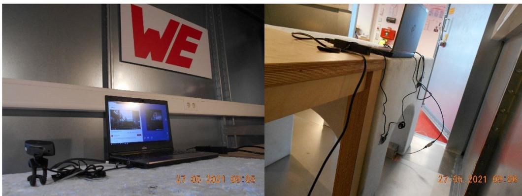
Abbildung 3: Aufbau der leitungsgeführten Störaussendungsprüfung des Prüflings. Verwendung eines geschirmten Ethernetkabels
