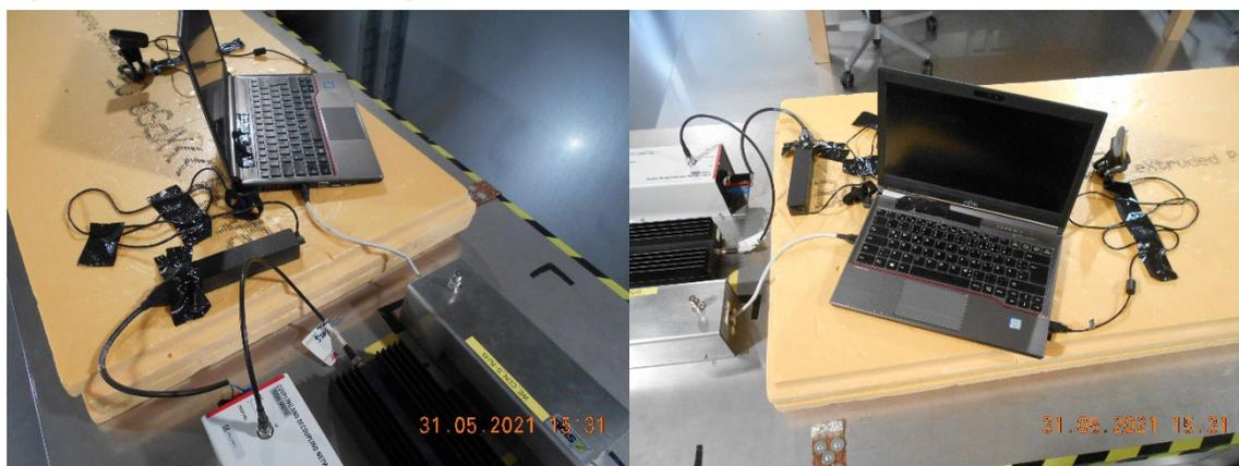
Abbildung 26: Aufbau der leitungsgeföhrt Störfestigkeitsprüfung am Notebook
